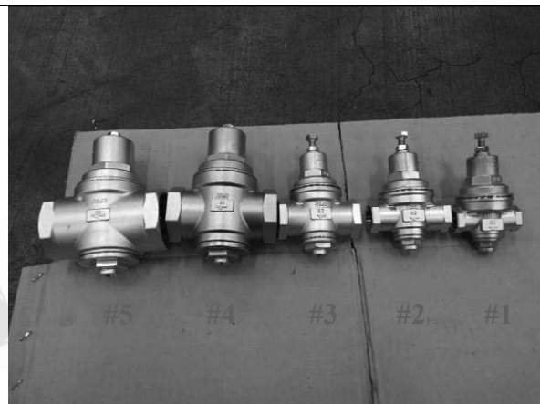
照片 B：測試樣品外觀 複合型-直動減壓閥(牙口)
