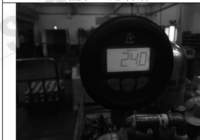
照片 E：測試中壓力表顯示
