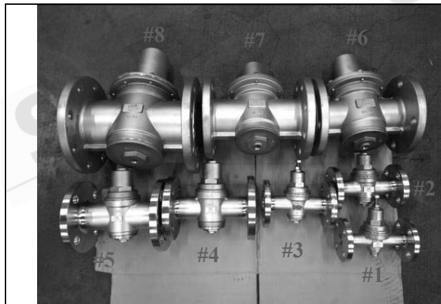
照片 A：測試樣品外觀 複合型-直動減壓閥(法蘭)
